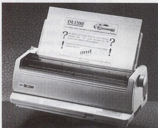
Der DL1200 bedruckt Formate bis DIN A3 quer
